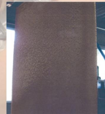
A seconda del modo di deposizione il metallo può essere recuperato come piastre catodiche (immagine a sinistra) o sotto forma di piccole sferule. In quest'ultimo caso l'unità è dotata di una serie di lame in plastica che distruggono i dotti. Le piccole sferule prodotte cadono sul fondo del cono e vengono scaricate dal fondo dell'apposita vasca di raccolta dotata di vetro di ispezione visiva (foto a destra).
